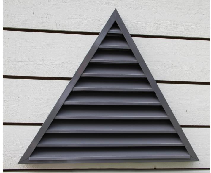
Tradisjonell fasaderist for utendørs luftinntak. Risten leveres med to alternative rammer - den ene har utenpåliggende flens (type FG1), og den andre er for innfelling (FG2). Lamellene er horisontale og skråstilte med avstand 50mm.
