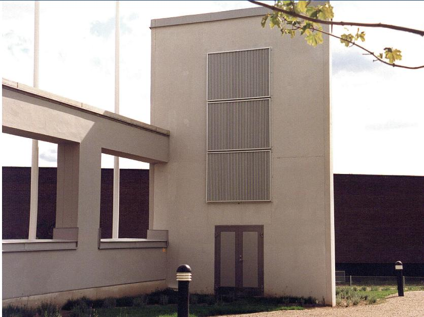
Galler anpassade för luftintag och utomhusbruk med en unik konstruktion som avskiljer och effektivt leder bort regn, snö och skräp. Gallret består av en perifer ram som bygger ut från väggen, samt en fast insats med stående lameller. Som standard levereras fasadgaller typ YGU natoranodiserat, men kan även fås anodiserad eller lackerad i valfri kulör
